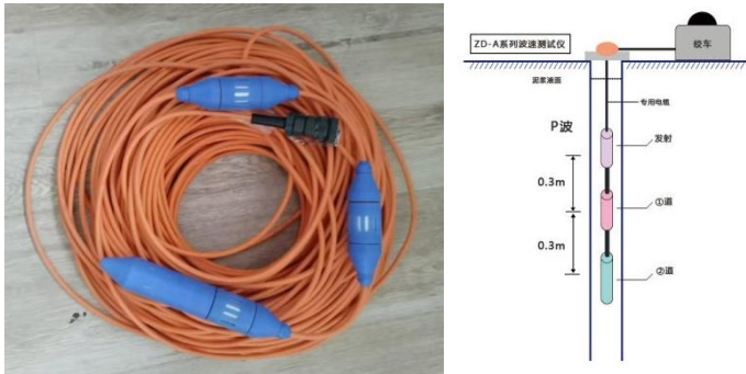
图 2-5-1 ZB100 声波测井探头外观
