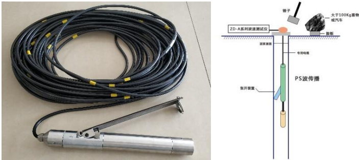
图 2-4-1 扣板式探头外观
